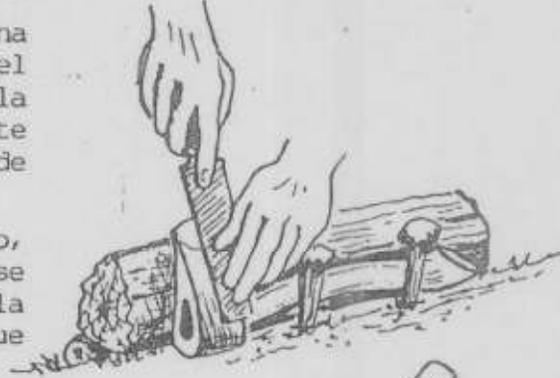
Termina el filo con una piedra de carborundo, empleando agua o aceite; el movimiento que se imprime a la hoja debe ser hacia adelante; y la inclinación debe ser muy regular a fin de que resulte un filo uniforme.
