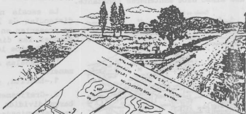
**Curvas de nivel o líneas de contorno.** Son las líneas que representan puntos de una misma altura sobre el nivel del mar. La diferencia en la altura del terreno entre una curva de nivel y la siguiente se llama **Intervalo de contorno**.
